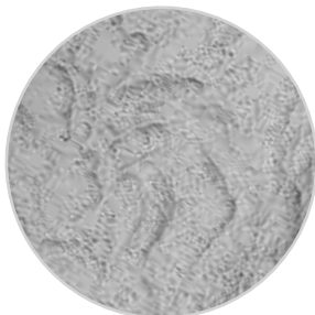
Superficie libre de residuos, implante MIS C1 (x 1000).
